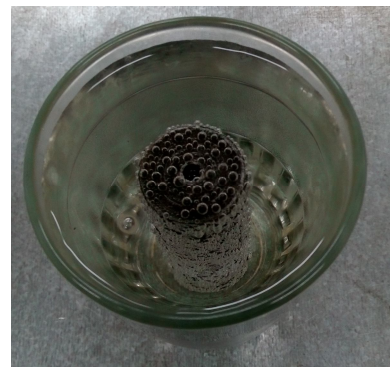
Gambar 2.5 Spesimen yang dimasukkan kedalam wadah berisi campuran HCL dan air
